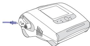
2. Schließen Sie den Steuerschlauch des Expirationsventils an. Drücken Sie ihn dazu auf den Anschluss und drehen Sie ihn um 90 Grad nach rechts.
