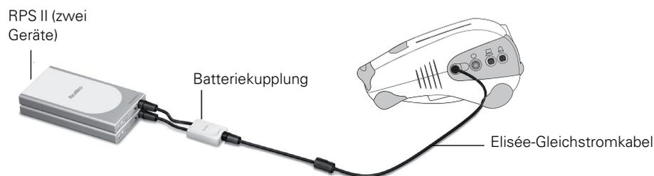
Abbildung 4.3: Anschluss der ResMed Power Station II (Konfigurationsbeispiel)
