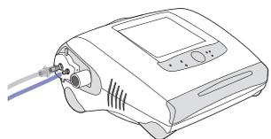
3. Schließen Sie den Steuerschlauch für den proximalen Druck an dem kleineren, abgestuften Anschluss an.
