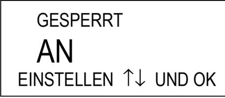
Schalten Sie durch Betätigung der Pfeil – Tasten von „AUS“ nach „AN“ und Bestätigen Sie mit der START / OK – Taste.
