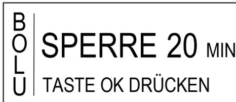
Geben Sie über das Ziffernfeld das Bolussperrintervall im Bereich von 0 – 255 min ein. Das Bolussperrintervall ist das Zeitintervall, in dem keine Bolusgabe erlaubt sein soll. Der Bolus wird innerhalb dieses Intervalls während der Infusion mit einem akustischen Signal abgelehnt. Außerhalb des Sperrintervalls ist die Bolusgabe möglich.
