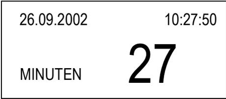
Die Minutenangabe kann durch Drücken der **Pfeiltasten** geändert werden (0-59 min). Bestätigen Sie die Eingabe der Minuten mit der START / OK – Taste (auch bei keiner Änderung).
