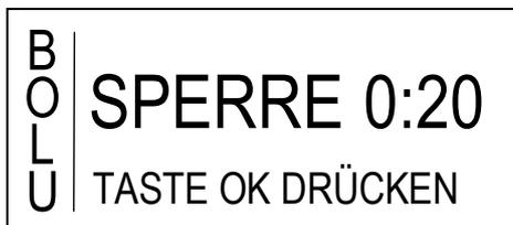
Geben Sie über das Ziffernfeld das Bolussperrintervall im Bereich von 0:00 – 4:15 h ein. Das Bolussperrintervall ist das Zeitintervall, in dem keine weitere Bolusgabe erlaubt ist. Der Bolus wird innerhalb dieses Intervalls während der Infusion mit einem akustischen Signal abgelehnt. Außerhalb des Sperrintervalls ist die Bolusgabe möglich.
