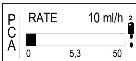
Voraussetzung für die Bolusgabe ist, dass sich die Infusionspumpe im Profil **PCA** befindet und mit der START / OK – Taste gestartet wurde. Es erscheint die links abgebildete Displayanzeige.
