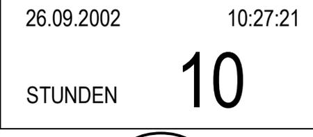
Die Zahl „10“ beschreibt die Stundenangabe (0-23h). Diese Angabe kann durch Drücken der **Pfeiltasten** geändert werden. Bestätigen Sie die Eingabe der Stunden mit der START / OK – Taste (auch bei keiner Änderung).
