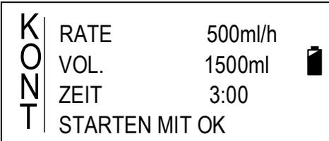
Sperren Sie das Profil aus einem START-Screen heraus. Die Infusionsparameter wurden am Beispiel **KONTINUIERLICH** bereits eingegeben.
