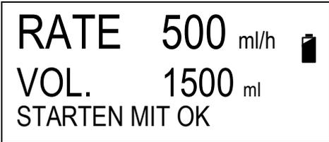
Die programmierten Infusionsparameter werden in einer Übersicht dargestellt. Das Korrigieren derer ist mit der STOP / NO – Taste möglich.
