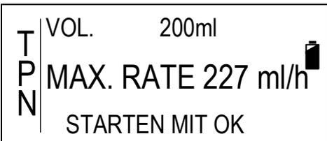
In der links abgebildeten Displayanzeige werden die zuvor eingegebenen Infusionsparameter und die errechnete maximale Rate zur Kontrolle dargestellt. Ein Korrigieren der Parameter ist mit der STOP / NO – Taste möglich.
