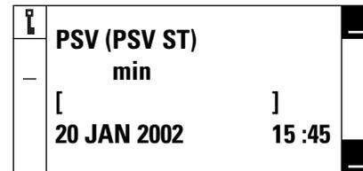
Die Rampe kann von 0 bis 25 Minuten in Abständen von 5 Minuten eingestellt werden. Um sie zu regeln, muss:
