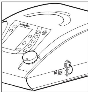
1. Der Einschub für die Speicherkarte befindet sich an der Seite des Gerätes unter einer Gummiabdeckung. Ziehen Sie an der Gummiabdeckung, um an die Speicherkarte zu gelangen.
