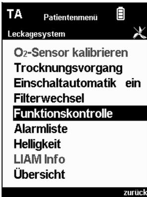
4. Schieben Sie mit Hilfe des Drehknopfes den schwarzen Auswahlbalken auf **Funktionskontrolle** und drücken Sie auf **ENTER**.
