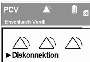
Wird durch einen Fehler ein Alarm ausgelöst (hier: Diskonnektionsalarm), können Sie durch Drücken der Alarm-Quittierungstaste
