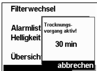
aktiv und zeigt die noch verbleibende Trocknungszeit an. Nach Ablauf des Trocknungsvorganges schaltet sich das Gerät aus.
