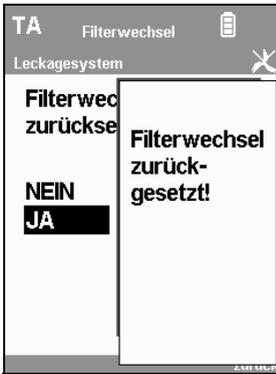
Wenn Sie **JA** mit dem Drehknopf ausgewählt und bestätigt haben, erscheint für ca. 3 Sekunden die Meldung **Filterwechsel zurückgesetzt!**
