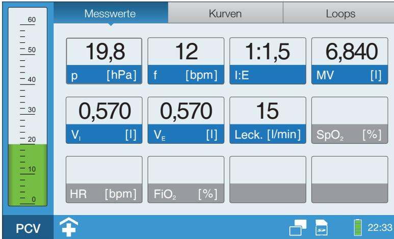
2. Navigieren Sie durch Drehen des MFK zu der Messwertbox, die Sie konfigurieren möchten. Drücken Sie den MFK, um die Messwertbox zu aktivieren.
