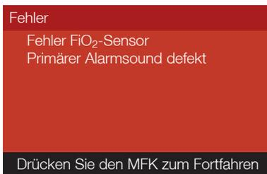
Durch Drücken des MFK werden anschließend die Defaultparameter geladen, d.h. das Gerät wird auf Werkseinstellungen zurückgesetzt. Falls die Beatmung aktiv ist, läuft sie mit Werkseinstellungen weiter. Das Gerät ist wieder voll bedienbar.
