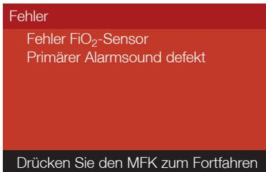
Durch Drücken des MFK wird die Fehlerliste ausgeblendet. Die Defaultparameter werden nicht geladen. Falls die Beatmung aktiv ist, läuft sie mit den benutzerdefinierten Einstellungen weiter. Eine Bedienung des Gerätes ist jedoch nicht mehr möglich.
