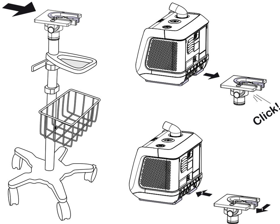
Die Grundplatte wird mit zwei Schrauben am Fahrgestell befestigt.
