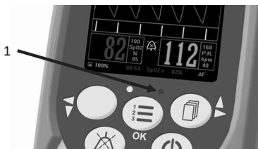
Abb. 74: rote Alarmanzeige hohe Priorität
