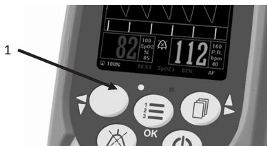
Abb. 75: gelbe Alarmanzeige mittlerer Priorität
