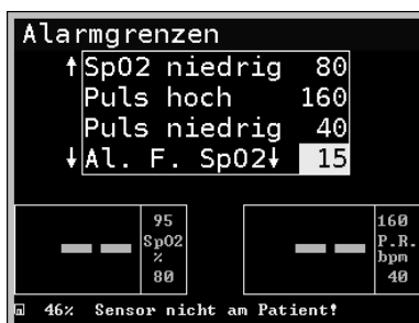
Abb. 50: Auswählen der Alarmfilterdauer
