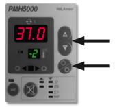
Rote Anzeige: Ist-Temperatur der Kammer (im Bsp: 37.0°C)
