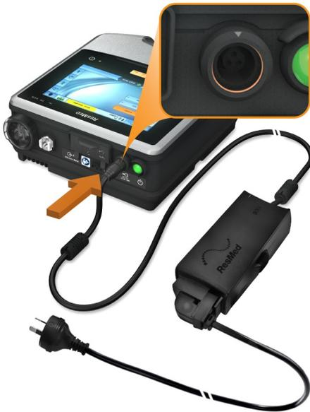
**Hinweis:** Das Netzkabel ist mit einem arretierenden Stecker zum Drücken und Ziehen ausgestattet. Um das Netzkabel abzunehmen, fassen Sie es am Gehäuse und ziehen Sie den Stecker vorsichtig aus dem Gerät. Sie sollten weder das Außengehäuse verdrehen noch am Kabel ziehen.
