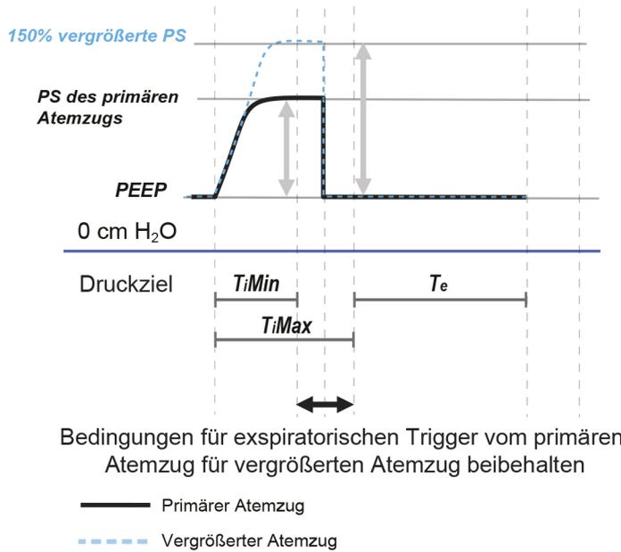
Bei volumenkontrollierten Atemzügen wird das Volumen vergrößert, indem zunächst die Flowkurve abgeflacht, dann  $T_i$  verlängert und schließlich der PIF angehoben wird. Dies gilt für kontrollierte Atemzüge im V(A)C-Modus und in den V-SIMV-Modi.
