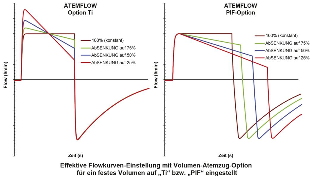
Die Abbildung zeigt die Auswirkung der Flowkurve auf die Atemzufuhr bei einem feststehenden Volumen. Ist die Volumenkontrollierte-Atemzugs-Option auf „PIF“ (Peak Inspiratory Flow, Maximaler Inspirationsflow) eingestellt, ändert sich durch Anpassung der Flowkurve die Inspirationsdauer. Ist die Volumenkontrollierte-Atemzugs-Option auf „Ti“ (Inspirationszeit) eingestellt, ändert sich durch Anpassung der Flowkurve der inspiratorische Spitzenflow.
