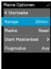
2. Drehen Sie am Bedienregler, bis „Rampe“ hervorgehoben wird, und drücken Sie dann den Bedienregler, um diese Option auszuwählen.
