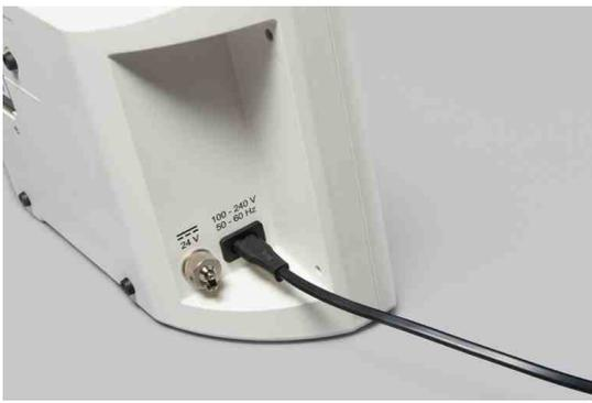
Nehmen Sie das mitgelieferte Netzkabel und verbinden Sie damit die Netzanschlussbuchse am Gerät mit einer Steckdose. Die vorhandene Spannung wird automatisch vom Gerät erkannt. Alternativ kann auch eine Versorgung über einen externen Akku erfolgen. Hierbei ist das Gerät von der Netzversorgung unabhängig. Für weitere Informationen ziehen Sie bitte die Gebrauchsanweisung des Akkus heran.
