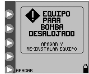
Figura 30. Pantalla de error de equipo para bomba desalojado.
