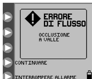
Figura 29. Schermata Errore di flusso.
