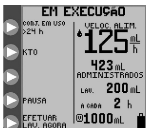
Figura 33. Ecrã de funcionamento com o indicador de utilização de definição de bomba > 24 h no canto superior esquerdo do ecrã.
