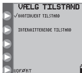
Figur 10B. Menuen VÆLG TILSTAND for valg af kontinuerlig eller intermitterende tilstand.
