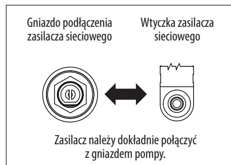
Rysunek 2. Ustawienie wtyczki zasilacza sieciowego względem gniazda wejściowego.
