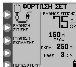
Εικόνα 5A. Αρχικό μενού ΦΟΡΤΩΣΗ ΣΕΤ για τη λειτουργία Συνεχούς σίτισης (δεν είναι ενεργοποιημένη η λειτουργία αντλίας EZ).
