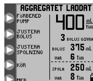
Figur 7D. Öppningsmeny för intermittent matningsläge med ett matnings- och spolningsset.
