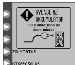
31. ábra: „Gyenge az akkumulátor” képernyő. Jelzi, hogy az akkumulátort haladéktalanul fel kell tölteni.
