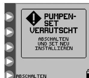
Abbildung 30: Fehlerbildschirm „Pumpenset verrutscht“
