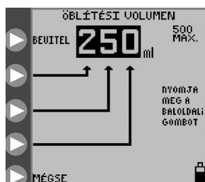
14B ábra: Öblítési volumen beállítása
