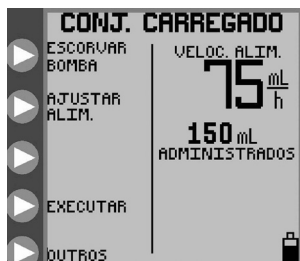
Figura 7A. Menu de abertura para modo de alimentação contínua com conjuntos de bomba apenas de alimentação
