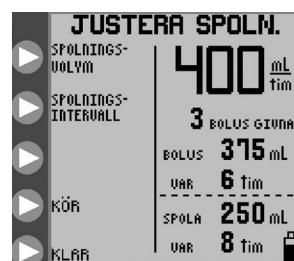
Figur 14A. JUSTERA SPOLNING-meny, intermittent läge.
