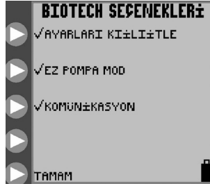
Şekil 22. Kilit Ayarı, EZ POMPA MODU ve Haberleşme özellikleri etkinken BioTech seçeneği ekranı. (Sadece servis profesyonelleri için Haberleşme Modu)
