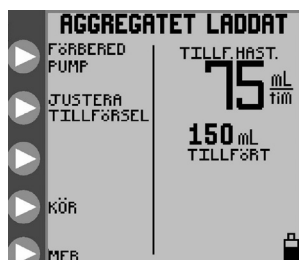
Figur 7A. Öppningsmeny för kontinuerligt matningsläge med ett set för endast matning.
