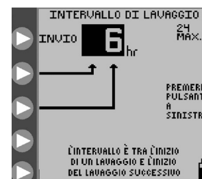
Figura 14C. Impostazione dell'intervallo di tempo del lavaggio.
