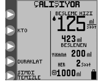
Şekil 15A. Sürekli besleme modu için ÇALIŞMA modu ekranı.
