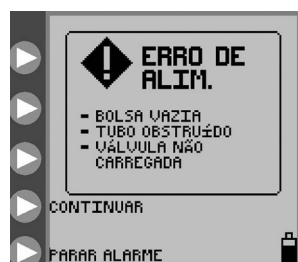
Figura 27. Ecrã de erro de alimentação
