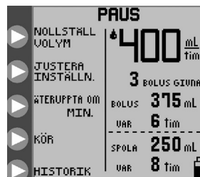
Figur 18B. Läget PAUS alternativ, intermittent matningsläge
