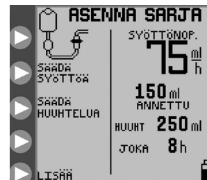
Kuva 5A. ASENNA SARJA -avausvalikkonäyttö, jatkuva ruokintatila (EZ-pumpputila ei ole aktiivinen)
