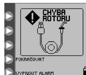
Obrázek 26. Obrazovka Chyba rotoru. Znovu založte hadičky soupravy a stiskněte tlačítko POKRAČOVAT .
