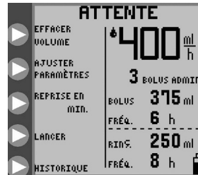
Figure 18B. Options du mode PAUSE mode d'alimentation intermittent.
