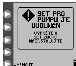
Obrázek 30. Obrazovka Chyby vysunutí soupravy pumpy.
