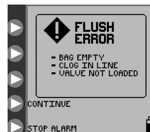
Рисунок 28. Экран ошибки промывания
