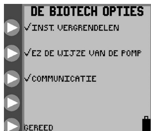
Afbeelding 22. BioTech-optiescherm, met de functies Instellingen vergrendelen, EZ POMPMODUS (EZ DE WIJZE VAN DE POMP) en Communicatie geactiveerd. (Communicatiemodus uitsluitend voor monteurs)
