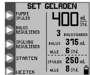
Abbildung 7D: Ausgangsmenü für die Nahrungszufuhr im Intervallbetrieb bei einem Ernährungs-/Spülset
