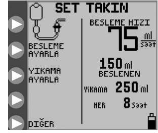
Şekil 5A. Sürekli Besleme modu için SET TAKIN açılış menüsü ekranı (EZ Pompa Modu aktif değil).
