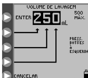
Figura 14B. Definição do volume de enxaguamento.
