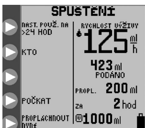
Obrázek 33. Obrazovka provozu s Ukazatelem používání sady pumpy > 24 HOD. v levém horním rohu obrazovky.
