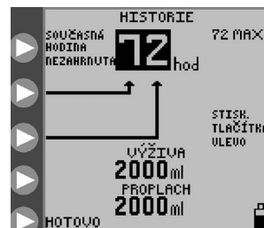
Obrázek 20. Celkové objemy podávání výživy a proplachování po dobu až 72 hodin předchozí historie s vyloučením dat za poslední hodinu.
