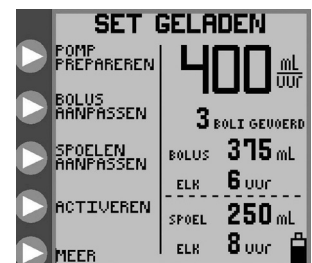
Afbeelding 7D. Openingsmenu voor de modus Intermitterende voeding met een voedings- en spoelset.
