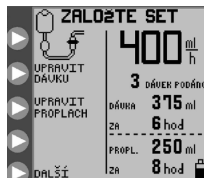
Obrázek 5B. ZALOŽTE SET obrazovka úvodní nabídky pro režim přerušovaného podávání výživy (Režim pumpy EZ není aktivní).
