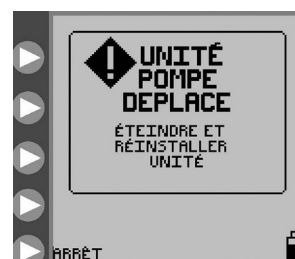
Figure 30. Écran Erreur Dispositif de pompe délogé.
