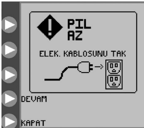
Şekil 31. PİL AZ hata ekranı. Bataryanın derhal şarj edilmesi gerektiğini belirtir.
