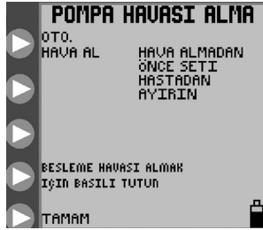
Şekil 8A. Sadece Besleme seti için POMPA HAVASI ALMA.
