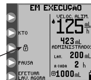
Figura 17. O cadeado indica que a bomba está em modo BLOQUEAR ECRÃ.
