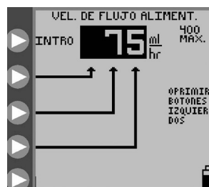
Figura 11B. Selección de la velocidad de alimentación.
