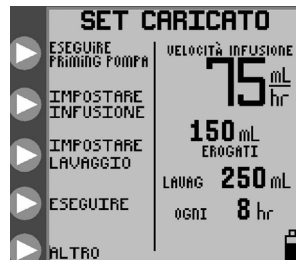
Figura 7B. Menu di apertura per la modalità di infusione intermittente con un set di alimentazione e lavaggio.
