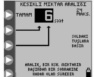
Şekil 13E. Bolus başlangıçları arasındaki zaman aralığını ayarlama.
