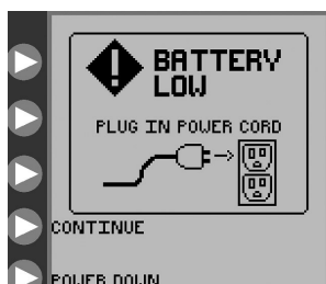
Рисунок 31. Экран ошибки BATTERY LOW (БАТАРЕЯ РАЗРЯЖЕНА) (указывает на то, что батарею нужно зарядить незамедлительно)
