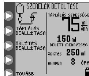
5A ábra: KÖSSÖN BE SZERELÉKET nyitó képernyő folyamatos tápláláshoz (EZ pumpa mód nincs bekapcsolva)
