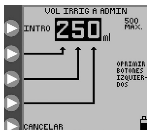
Figura 14B. Selección del volumen de irrigación.
