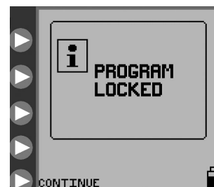
Рисунок 16. Экран «Программа заблокирована», который указывает на то, что насос находится в режиме LOCK SETTINGS (ЗАБЛОКИРОВАТЬ НАСТРОЙКИ)
