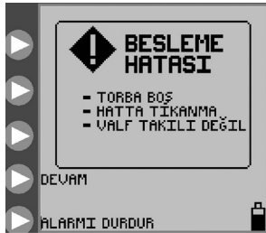
Şekil 27. Besleme Hatası ekranı.
