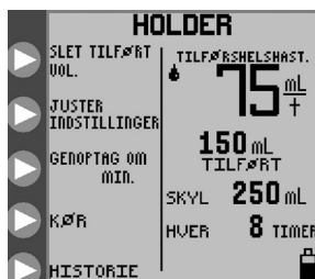
Figur 18A. Valgmuligheder for tilstanden HOLDER , kontinuerlig ernæringstilstand.
