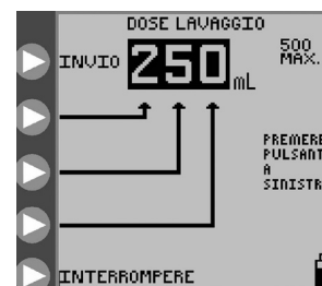
Figura 14B. Impostazione la dose di lavaggio.
