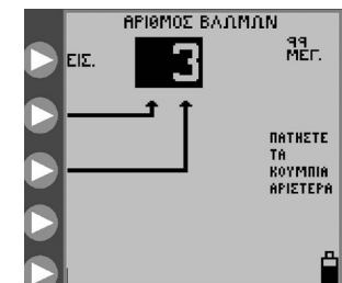
Εικόνα 13C. Ρύθμιση του πλήθους bolus.
