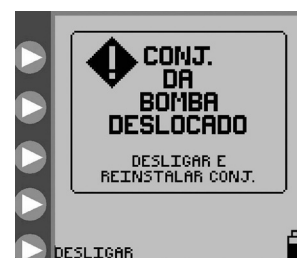
Figura 30. Ecrã de erro da deslocação de conjunto da bomba
