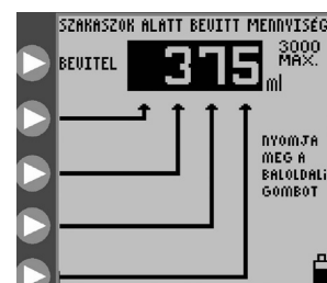
13D ábra: Szakaszonkénti térfogat beállítása
