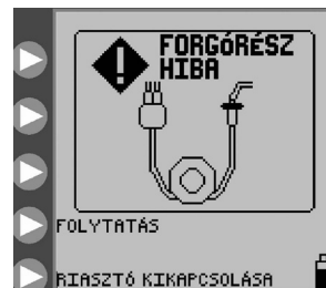
26. ábra: „Forgórész hiba” képernyő Kösse be újra a szerelék csövet és nyomja meg a FOLYTATÁS -t.
