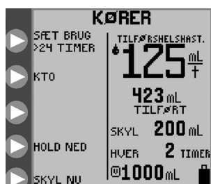
Figur 33. Skærmen Kører med indikator for brug af pumpesæt i 24 timer i øverste venstre del af skærmen.
