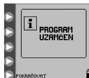
Obrázek 16. Obrazovka Program uzamčen, která znamená, že pumpa je v režimu NASTAVENÍ ZÁMKU.
