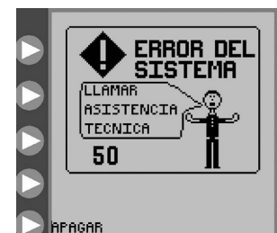
Figura 24. Pantalla de error general del sistema. Consulte la sección Servicio de atención al cliente.
