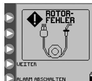
Abbildung 26: Rotorfehler-Bildschirm. Die Leitung des Sets neu verlegen und WEITER drücken.
