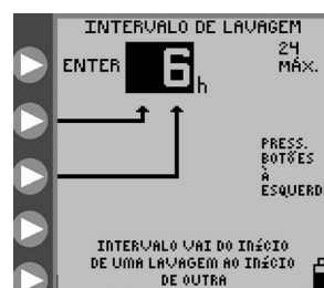
Figura 14C. Definição do intervalo de tempo de enxaguamento.
