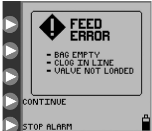
Рисунок 27. Экран ошибки подачи питания
