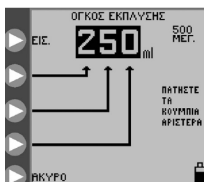
Εικόνα 14B. Ρύθμιση του όγκου έκπλυσης.
