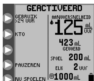
Afbeelding 33. Scherm GEACTIVEERD met de indicator voor Gebruik van de pompset > 24 uur linksboven op het scherm.
