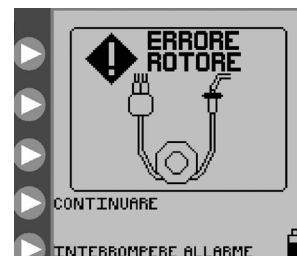
Figura 26. Schermata Errore rotore. Ricaricare il set di tubi e premere CONTINUARE.
