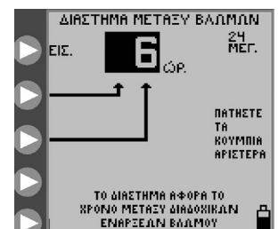
Εικόνα 13E. Ρύθμιση του χρονικού διαστήματος μεταξύ των ενάρξεων των bolus.
