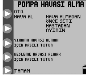
Şekil 8B. Besleme & Yıkama seti için POMPA HAVASI ALMA.
