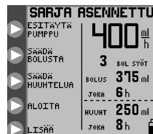
Kuva 7D. Avausvalikko, jaksottainen ruokintatila, ruokinta- ja huuhtelusarja
