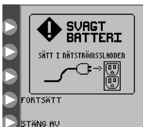
Figur 31. Felskärmen Låg batterinivå. Anger att batterierna måste laddas om direkt.
