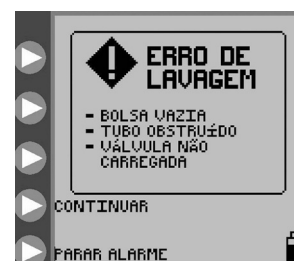
Figura 28. Ecrã de erro de enxaguamento.
