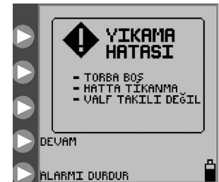
Şekil 28. Yıkama Hatası ekranı.
