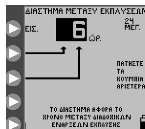
Εικόνα 14C. Ρύθμιση του χρονικού διαστήματος έκπλυσης.
