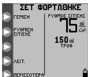
Εικόνα 7A. Αρχικό μενού για τη λειτουργία Συνεχούς σίτισης με Σετ μόνο για σίτιση.
