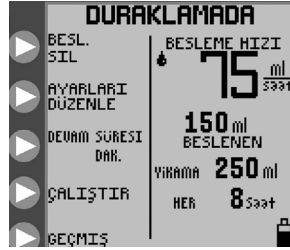
Şekil 18A. DURAKLAMADA modu seçenekleri, sürekli besleme modu.
