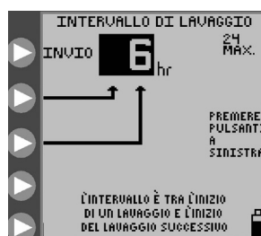
Figura 12C. Impostazione dell'intervallo di tempo del lavaggio.
