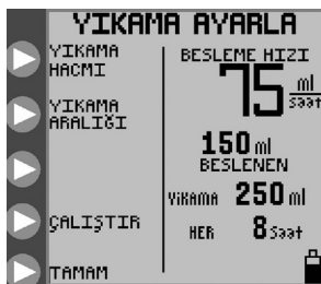
Şekil 12A. YIKAMAYI AYARLA menüsü, sürekli mod.
