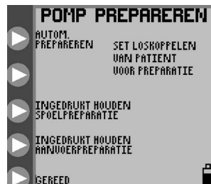
Afbeelding 8B. Menu POMP PREPAREREN voor de voedings- en spoelset.
