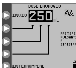
Figura 12B. Impostazione della dose di nutrimento.
