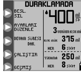
Şekil 18B. DURAKLAMADA modu seçenekleri, aralıklı besleme modu.
