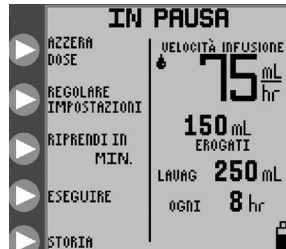
Figura 18A. Opzioni della modalità IN PAUSA, modalità di infusione continua.
