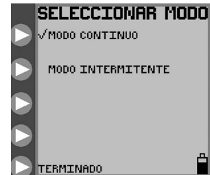
Figura 10B. Menú SELECCIONAR MODO para selección de modo continuo o intermitente.
