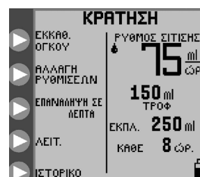
Εικόνα 18Α. Επιλογές λειτουργίας ΚΡΑΤΗΣΗ, λειτουργία συνεχούς σίτισης.
