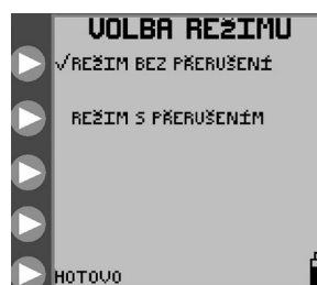
Obrázky 10B. Nabídka VOLBA REŽIMU pro volbu nepřetržitého a přerušovaného režimu
