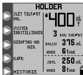
Figur 18B. Valgmuligheder for tilstanden HOLDER , intermitterende ernæringstilstand.
