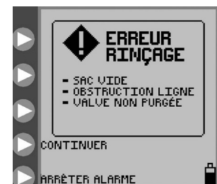
Figure 28. Écran Erreur de rinçage.
