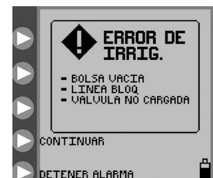
Figura 28. Pantalla de error de irrigación.
