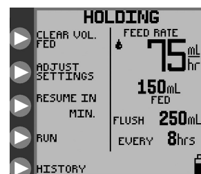
Рисунок 18А. Параметры режима HOLDING (ПАУЗА) , непрерывный режим подачи питания
