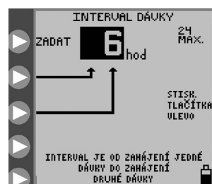
Obrázek 13E. Nastavení časového intervalu mezi spuštění bolusu.
