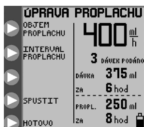
Obrázek 14A. Nabídka SEŘÍDIT PROPLACHOVÁNÍ režim přerušovaného podávání výživy.
