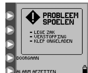
Afbeelding 28. Scherm Probleem spoelen.
