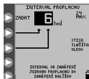
Obrázek 14C. Nastavení časového intervalu proplachování.
