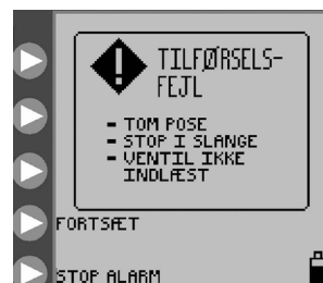
Figur 27. Skærm for tilførselsfejll.
