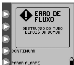
Figura 29. Ecrã de erro de fluxo.
