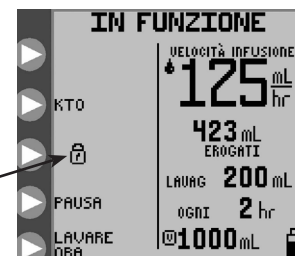
Figura 17. Il lucchetto chiuso indica che la pompa è in modalità di BLOCCO DELLO SCHERMO.
