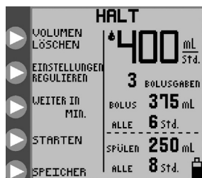
Abbildung 18B: Optionen im Zustand HALT bei Nahrungszufuhr im Intervallbetrieb
