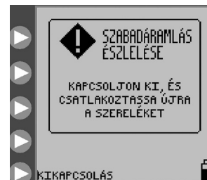
30. ábra : „Szabadáramlás észlelése” hiba képernyője
