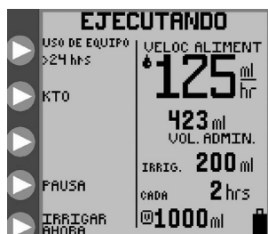
Figura 33. Pantalla de ejecución con el indicador de uso del equipo para bomba > 24 hr en la parte superior izquierda de la pantalla.
