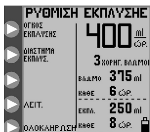
Εικόνα 14A. Μενού ΡΥΘΜΙΣΗ ΕΚΠΛΥΣΗΣ διαλείπουσα λειτουργία.
