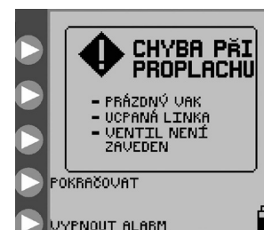
Obrázek 28. Obrazovka Chyba proplachování.
