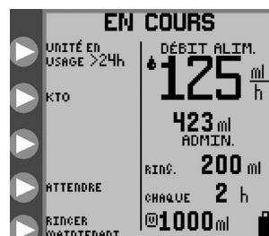
Figure 33. Écran Exécution avec indicateur de durée d'utilisation du set de pompe supérieur à 24 h dans le coin supérieur gauche de l'écran.
