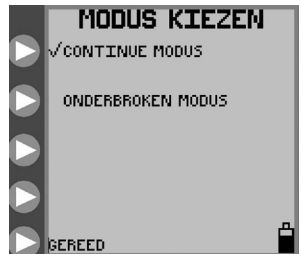
Afbeelding 10B. Menu MODUS KIEZEN SELECTEREN voor selecteren van de continu- of onderbroken modus.
