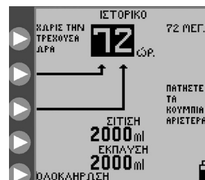
Εικόνα 20. Σύνολα σίτισης και έκπλυσης για έως και 72 ώρες ιστορικού, μη μπεριλαμβανομένων των δεδομένων της τρέχουσας ώρας.
