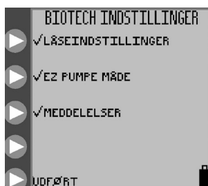
Figur 22. BioTech-skærm med funktionerne Lås indstilling, EZ-PUMPETILSTAND og kommunikation aktiveret. (Kommunikationstilstand kun for fagfolk)
