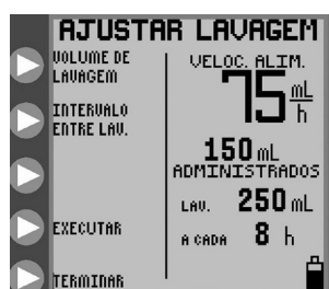
Figura 12A. Menu AJUSTAR LAVAGEM, modo contínuo.
