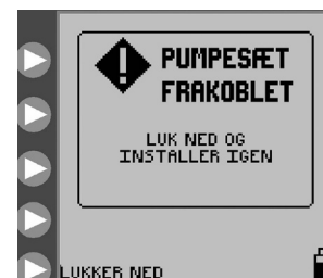
Figur 30. Skærm for fejl ved løsnet pumpesæt.
