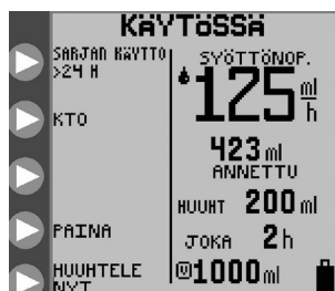
Kuva 33. Käynnissä-näyttö ja pumppu käytössä > 24 tuntia -ilmaisain vasemmassa yläkulmassa
