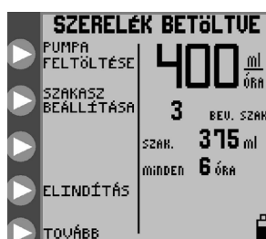
7C ábra: nyitómenü szakaszos tápláláshoz, csak táplálószerelékkel
