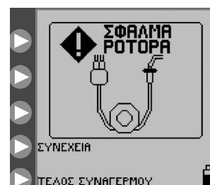
Εικόνα 26. Οθόνη σφάλματος ρότορα. Επαναφορτώστε τη σωλήνωση του σετ και πατήστε ΣΥΝΕΧΕΙΑ .
