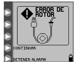
Figura 26. Pantalla de error del rotor. Vuelva a cargar los tubos del equipo y pulse CONTINUAR.
