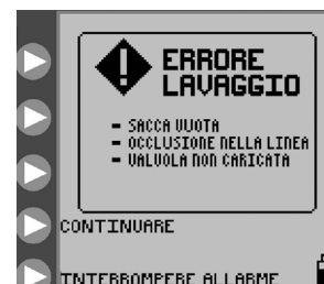
Figura 28. Schermata Errore lavaggio.
