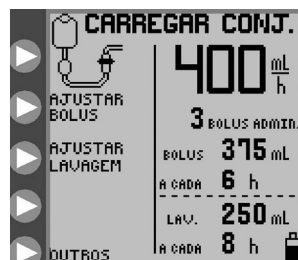
Figura 5B. CARREGAR UM CONJUNTO ecrã de menu de abertura para o modo de alimentação intermitente (Modo de Bomba EZ não ativado).
