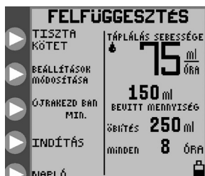
18A ábra: FELFÜGGESZTÉS mód opciói, folyamatos táplálás
