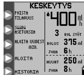
Kuva 18B. KESKEYTYS -tilan vaihtoehdot, jaksottainen ruokintatila
