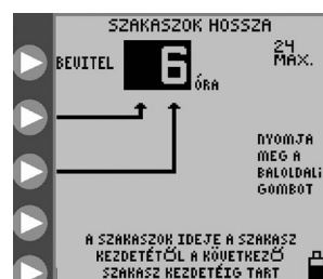
13E ábra: Szakaszok indítása közötti időintervallum beállítása
