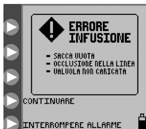
Figura 27. Schermata Errore infusione.
