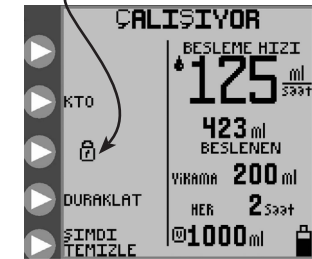
Şekil 17. Asma kilit pompanın EKRAN KİLİDİ modunda olduğunu gösterir.
