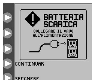
Figura 31. Schermata di errore della BATTERIA SCARICA. Indica che è necessario ricaricare la batteria immediatamente.
