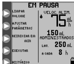
Figura 18A. Opções de modo EM PAUSA, modo de alimentação contínuo.
