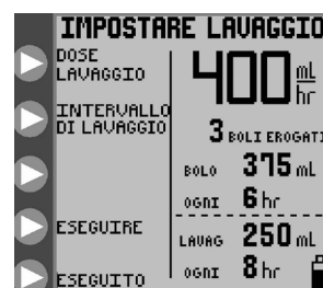
Figura 14A. Menu IMPOSTARE LAVAGGIO modalità intermittente.
