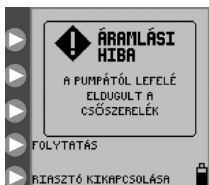
29. ábra: „Áramlási hiba” képernyő
