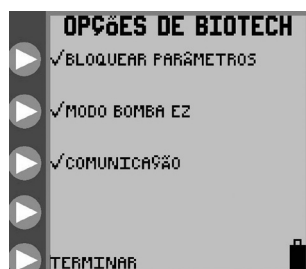
Figura 22. Ecrã de Opções de BioTech, com bloqueio de definição, MODO BOMBA EZ e funcionalidades de comunicação ativadas. (Modo de comunicação para profissionais de manutenção apenas).
