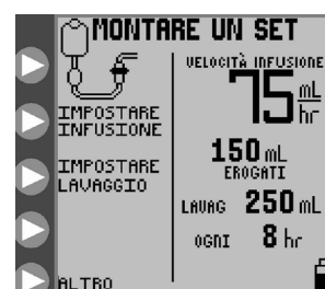
Figura 5A. Schermata MONTARE UN SET del menu di apertura per la modalità di infusione continua (Modalità della pompa EZ non attivata).
