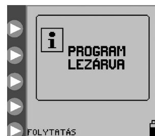
16. ábra „Program Zárolva” épernyő, mely jelzi, hogy a pompa „BEÁLLÍTÁSOK ZÁROLÁSA” üzemmódban van
