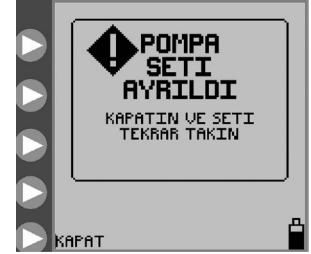
Şekil 30. POMPA SETİ AYRILDI Hatası ekranı.
