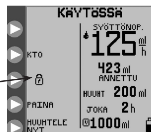
Kuva 17. Lukko osoittaa, että pumppu on NÄYTTÖLUKITUS-tilassa.
