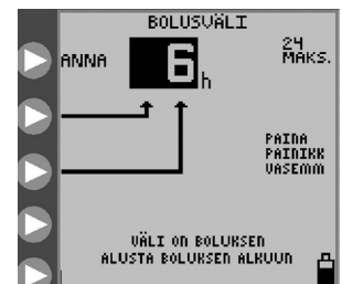
Kuva 13E. Bolusten antokertojen alkamisen aikavälin asetus
