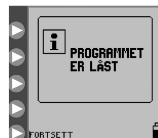
Figure 16. Skjermen Program låst, som indikerer at pumpen er i modusen LÅS INNSTILLINGER .
