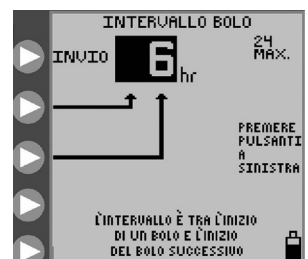
Figura 13E. Impostazione dell'intervallo di tempo che deve intercorrere tra l'avvio di un bolo e il successivo.
