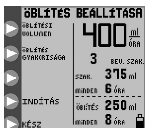
14A ábra: ÖBLÍTÉS BEÁLLÍTÁSA menü, szakaszos üzemmód
