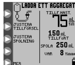
Figur 5A. LADDA ETT AGGREGAT, öppningsmeny för kontinuerlig matning (EZ-pumpprogram inte aktiverat).
