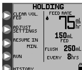
Rysunek 18A. Opcje trybu HOLDING (WSTRZYMANIE), ciągły tryb żywienia.
