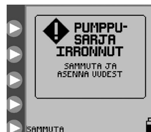
Kuva 30. Pumppusarja irronnut -vikaen näyttö
