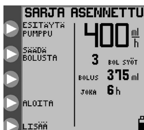
Kuva 7C. Avausvalikko, jaksottainen ruokintatila, vain ruokinta-sarja
