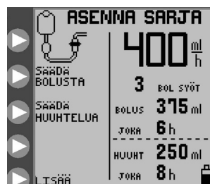
Kuva 5B. ASENNA SARJA -avausvalikkonäyttö, jaksottainen ruokintatila (EZ-pumpputila ei ole aktiivinen)
