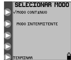
Figura 10B. Menu SELECIONAR MODO para seleção de modo contínuo ou intermitente.
