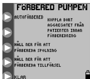
Figur 8B. FÖRBERED PUMPEN-meny för matnings- och spolningsset.
