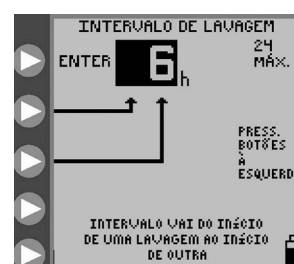
Figura 12C. Definição do intervalo de tempo de Lavagem .
