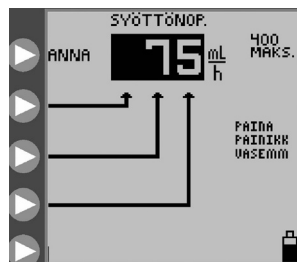
Kuva 11B. Ruokintanopeuden asetus
