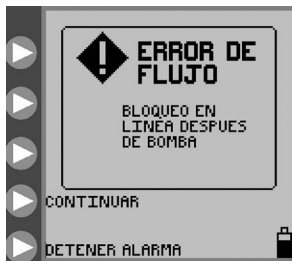
Figura 29. Pantalla de error de flujo.
