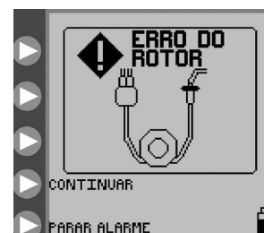
Figura 26. Ecrã de erro de rotor. Recarregue o tubo do conjunto e pressione CONTINUAR.
