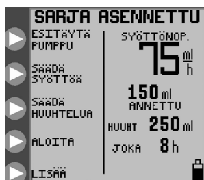
Kuva 7B. Avausvalikko, jatkuva ruokintatila, ruokinta- ja huuhtelusarja
