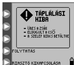
27. ábra: „Táplálási hiba” képernyő
