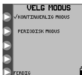
Figur 10B. VELG MODUS-menyen for valg av kontinuerlig eller periodisk modus.
