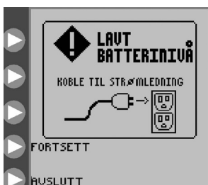
Figur 31. Lavt batterinivå-skjermen. Indikerer at batteriet må lades opp umiddelbart.
