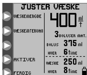
Figur 14A. JUSTER VÆSKE-menyen, periodisk modus.
