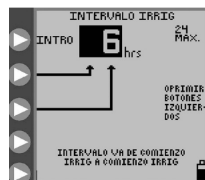
Figura 14C. Selección del intervalo de tiempo de irrigación.
