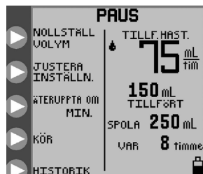
Figur 18A. Läget PAUS alternativ, kontinuerligt matningsläge
