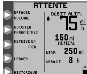
Figure 18A. Options du mode PAUSE , mode d'alimentation continu.
