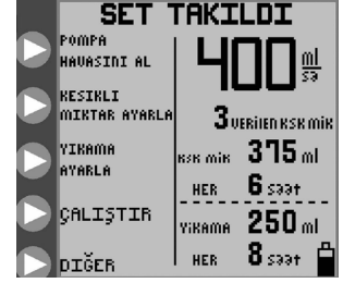
Şekil 7D. Besleme & Yıkama setiyle Aralıklı Besleme modu için açılış menüsü.
