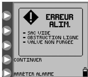
Figure 27. Écran d'erreur d'alimentation.
