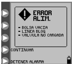
Figura 27. Pantalla de error de alimentación.
