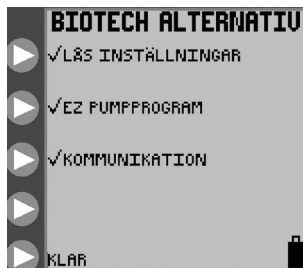
Figur 22. BioTech-alternativskärmen, med låsinställningar, EZ-PUMPPROGRAM, och kommunikationsfunktionerna aktiverade. (Kommunikationsläget är endast för servicetekniker)
