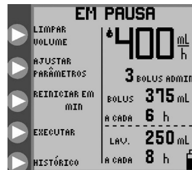
Figura 18A. Opções de modo EM PAUSA, modo de alimentação intermitente.
