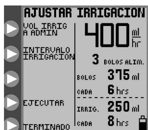
Figura 14A. Menú AJUSTAR IRRIGACIÓN , modo intermitente.
