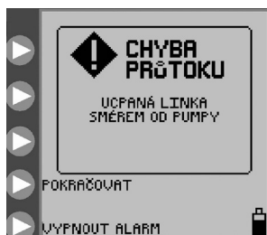
Obrázek 29. Obrazovka Chyba průtoku.
