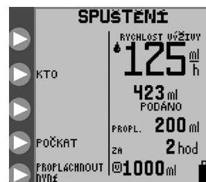
Obrázek 15A. Obrazovka režimu V PROVOZU v režimu nepřetržitého podávání výživy.
