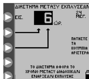
Εικόνα 12C. Ρύθμιση του χρονικού διαστήματος έκπλυσης.
