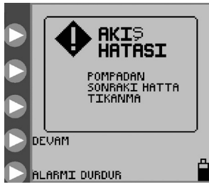
Şekil 29. Akış Hatası ekranı.
