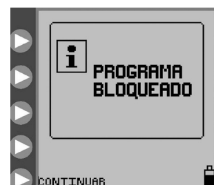
Figura 16. Pantalla Programa bloqueado, que indica que la bomba está en modo BLOQUEAR AJUSTES .
