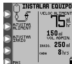
Figura 5A. Pantalla del menú inicial INSTALAR EQUIPO para el modo de alimentación continua (modo EZ de la bomba no activado).
