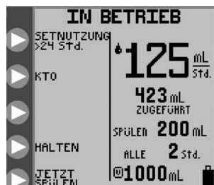
Abbildung 33: Bildschirm „In Betrieb“ mit Anzeige „Setnutzung > 24 Std.“ oben links auf dem Bildschirm
