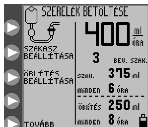
5A ábra: KÖSSÖN BE SZERELÉKET nyitó képernyő szakaszos tápláláshoz (EZ pumpa mód nincs bekapcsolva)
