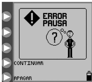
Figura 25. Pantalla de error de pausa.
