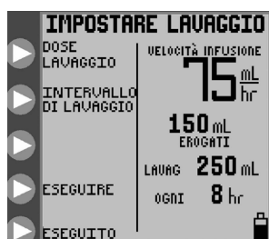
Figura 12A. Menu IMPOSTARE LAVAGGIO modalità continua.
