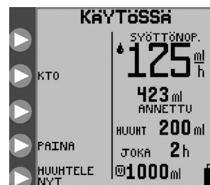
Kuva 15A. KÄYNNISSÄ-tilan näyttö, jatkuva ruokintatila
