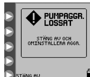
Figur 30. Skärmen Fel – Pumpaggregatet lossat.
