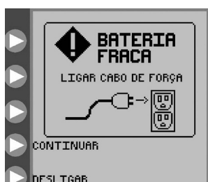
Figura 31. Ecrã de erro de bateria fraca. Indica que a bateria deve ser imediatamente carregada.
