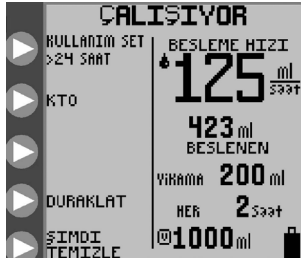
Şekil 33. Ekranın sol üstünde > 24 SAAT Pompa Seti Kullanımı göstergesiyle çalışma ekranı.
