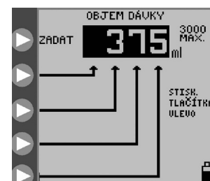
Obrázek 13D. Nastavení objemu pro jednotlivé bolusy.
