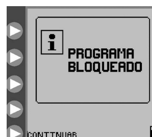
Figura 16. Ecrã de programa bloqueado, que indica que a bomba está no modo PROGRAMA BLOQUEADO.
