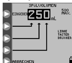
Abbildung 12B: Einstellung des Spülvolumens
