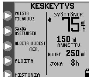
Kuva 18A. KESKEYTYS -tilan vaihtoehdot, jatkuva ruokintatila
