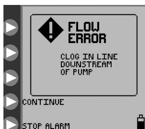
Рисунок 29. Экран ошибки потока
