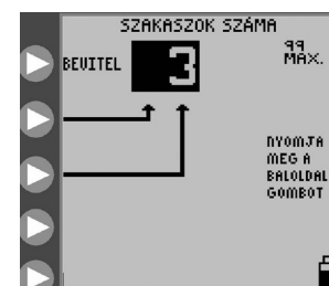
13C ábra: Szakaszok számának beállítása
