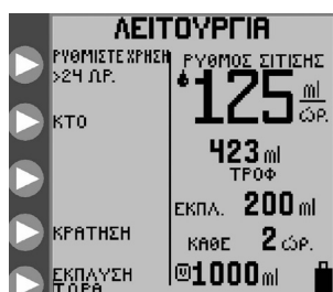
Εικόνα 33. Οθόνη Λειτουργία με την ένδειξη για τις > 24 ΩΡΕΣ χρήσης του Σετ αντλίας στο επάνω αριστερά μέρος της οθόνης.
