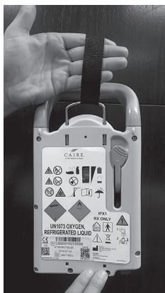
Sprawdzanie wskaźnika napełnienia modułu H300/H850
