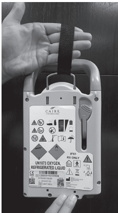
A H300/H850 hordozható egység úrtartalomjelzőjének ellenőrzése
