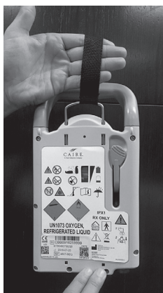
Kontrola ukazatele obsahu jednotky H300/H850
