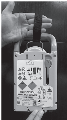
Kontrollera nivåindikatorn på H300/H850
